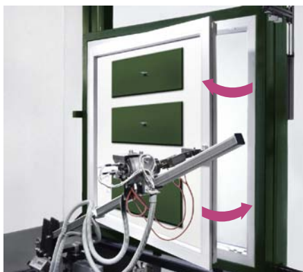
Fensterprüfstand für Dauerbelastungen
